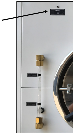
Indicador visual de falta de agua
